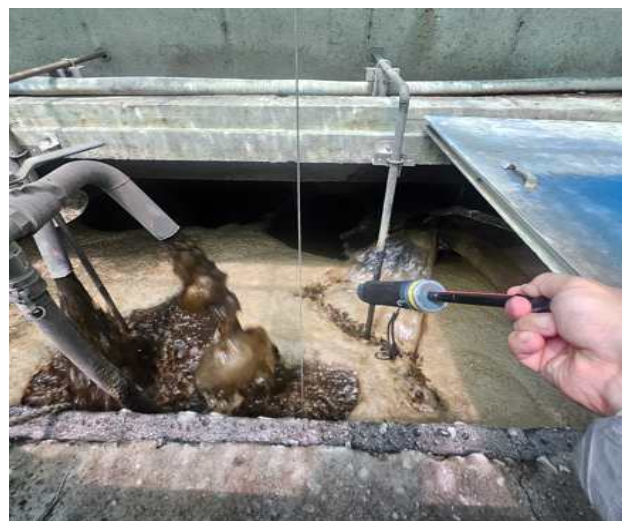
액비 폭기조 암모니아 측정
