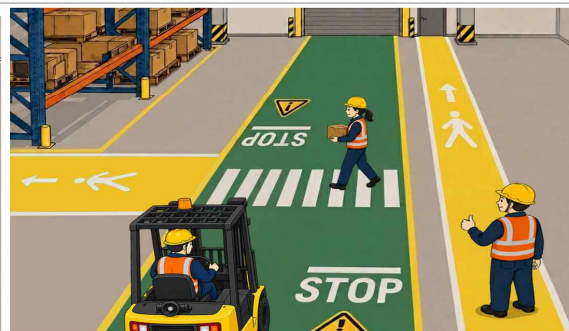
(개선 후) 보행로, 지게차 통행로 구분하여 표시
