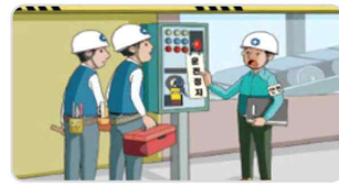
기동장치, 잠금조치, 표지판 설치
