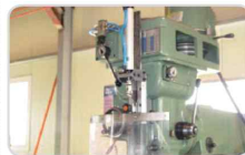
〈가동 중 덮개 설치〉
