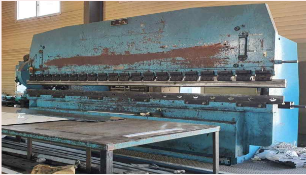
안전장치가 미설치된 노후 절곡기(철판을 굽히거나 접는 기계)에서 작업 시 금형사이에 끼임재해 위험
