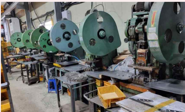
방호장치가 미설치된 노후 프레스에 인력에 의한 소재투입 및 취출작업에 따른 끼임재해 위험
