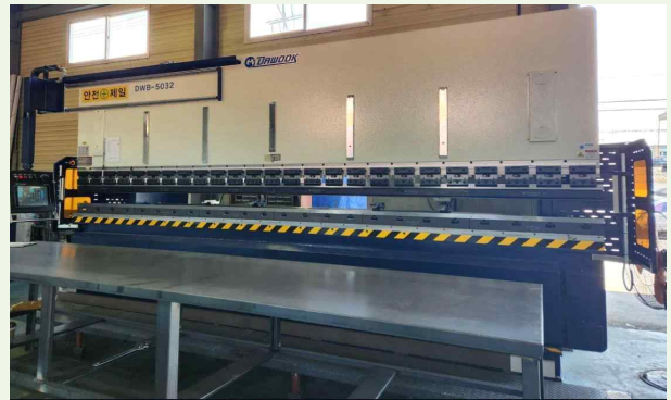
안전장치 및 금형 자동교체장치가 설치된 신규 절곡기 사용으로 끼임 재해예방
