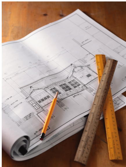
한옥은 우리나라의 전통 건축양식으로 지은 집으로 난방을 위한 온돌과 방방을 위한 마루가 균형있게 결합된 구조를 갖추고 있다. 사진은 한옥 설계도
