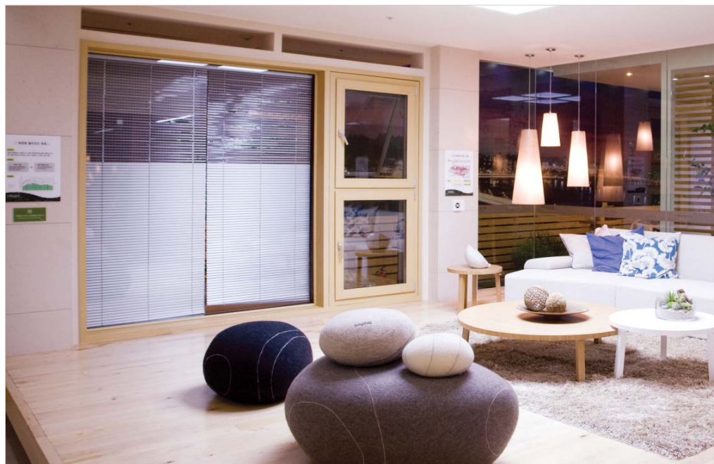
강남구 역삼동에 위치한 '푸르지오 밸리' 상설 주택문화관의 에너지 제로(zero) 아파트 내부. 북층 유리 안에 태양전지(solar cell)가 생산한 전기 에너지로 블라인드 각도를 자동 조절해 채광량을 맞추고 실내온도를 관리할 수 있다.
