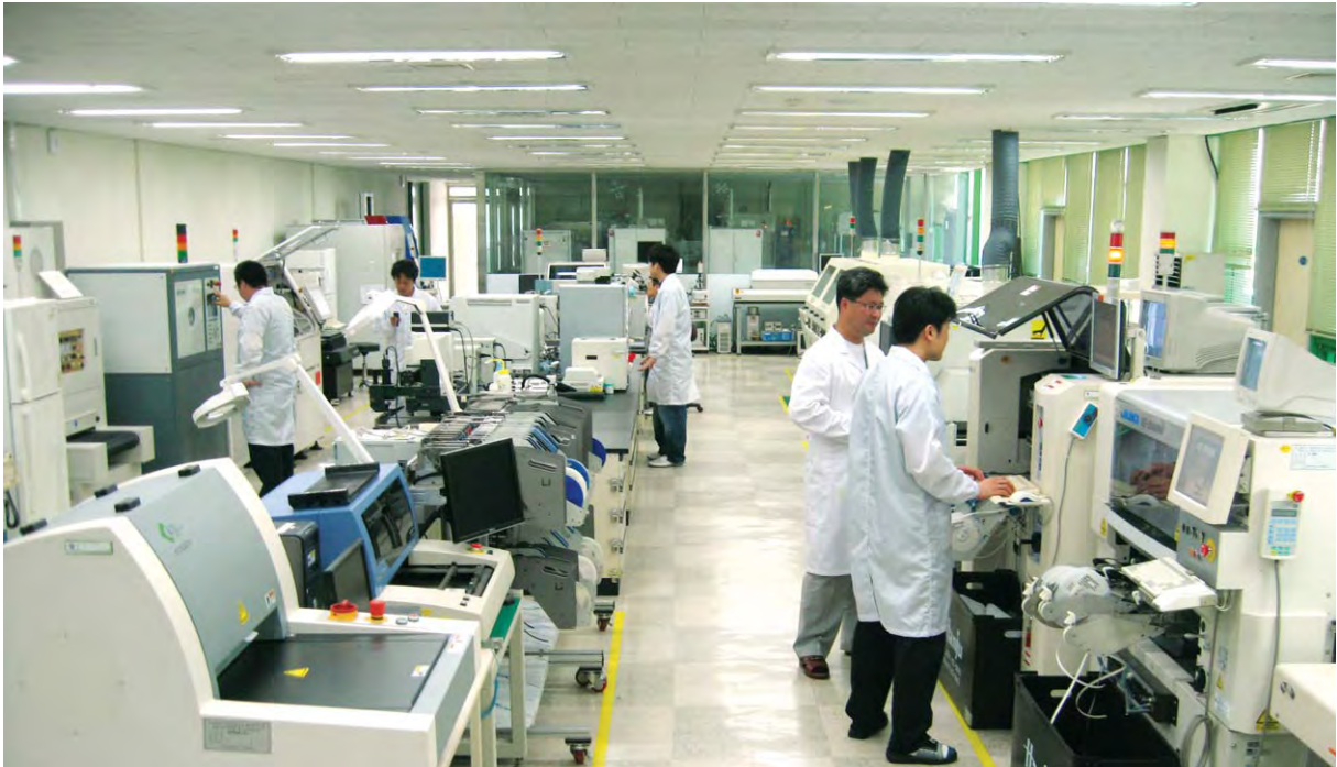
한국생산기술연구원이 운영하고 있는 마이크로조이닝센터 내부 모습. 이곳에서는 전자패키징 · 미세용접 분야 제품 개발 후 성능테스트를 할 수 있다. 마이크로조이닝(micro-joining)이란 2개 이상의 소재와 부품 등을 기계 · 전기적으로 결합시키는 초정밀 조립기술로, 정밀접합 및 전자패키징 분야를 포괄한다.
